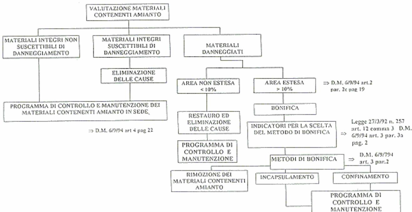
L'art. 7 comma 7- a) fornisce i "principali indicatori utili per valutare lo stato di degrado delle coperture in cementoamianto" che danno utili indicazioni sull'opportunità di procedere alla bonifica mediante incapsulamento. La tabella 2 fornisce il diagramma di flusso delle operazioni da effettuare per l'incapsulamento dei manufatti in cementoamianto ed indica compiti e responsabilità dei diversi organismi.
